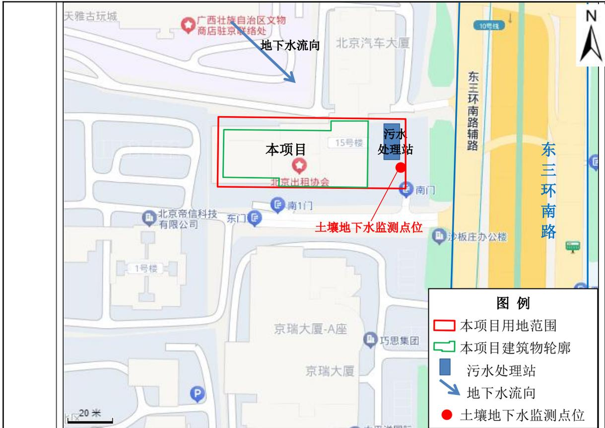
图 3-3 土壤、地下水监测点位示意图
