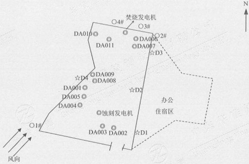
2025.06.18 废气监测点位示意图: ○表示无组织废气监测点, ⊙表示有组织废气监测点, ☆表示地下水监测点
